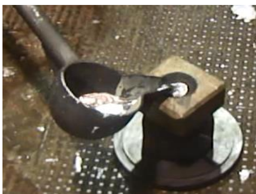
Figura 45 – Vazamento em coquilha Tatur com bacia acoplada.
