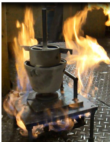
Figura 58 – Aquecimento da coquilha espiral com sistema de queimadores a gás
