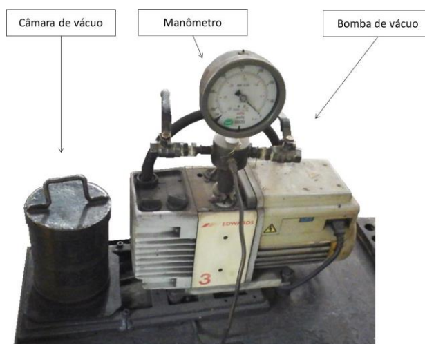
Figura 35 – Equipamento gerador de vácuo para produção de amostras para controles de densidades.
