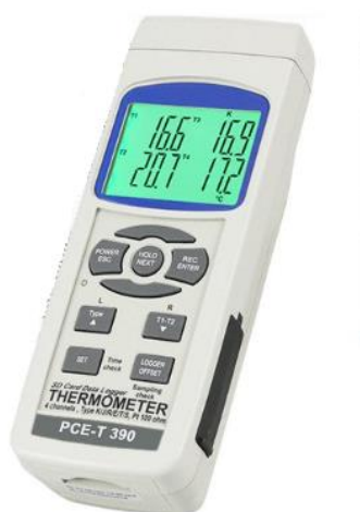
Figura 37 – Equipamento para controle térmico da liga, Data Logger PCE-T 390
