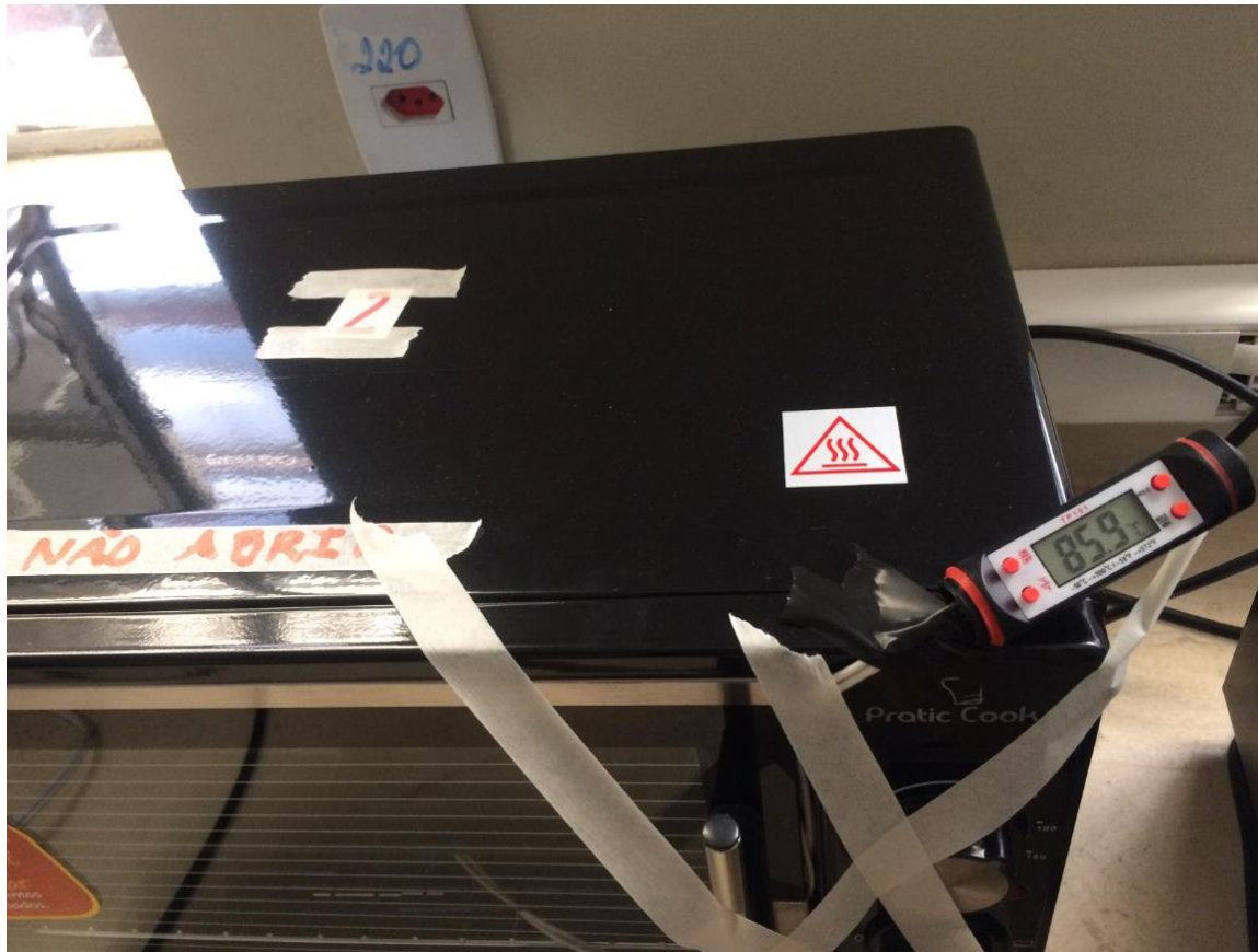
Figura 38: Detalhe do termômetro utilizado para controle da temperatura interna dos fornos.
