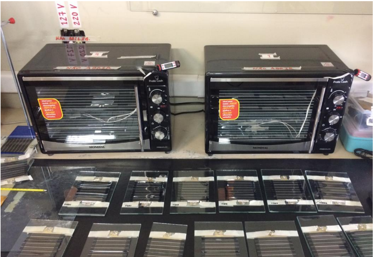
Figura 36: Fornos com arranjo de ajuste de temperatura usados para degradação de células OSC.
