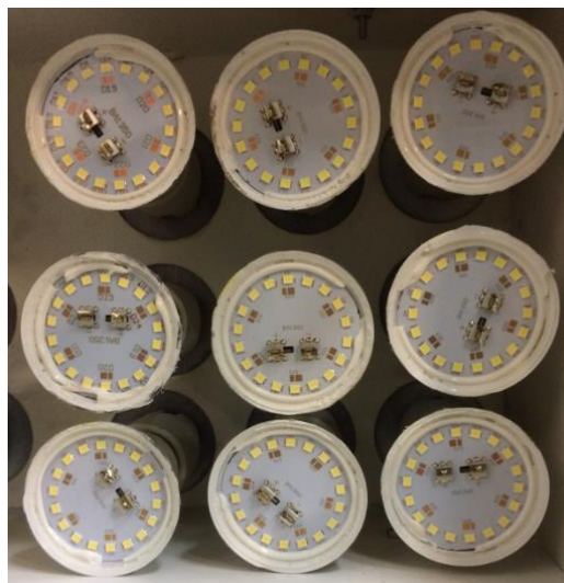
Figura 27: Detalhe do arranjo de lâmpadas de LED usadas no simulador solar.
