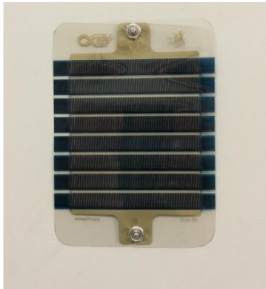
Figura 21: Células solares orgânicas (OSC) utilizadas neste trabalho experimental.
