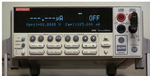
Figura 25: Unidade medidora SMU ( source meter unit ) modelo KEITHLEY 2400.
