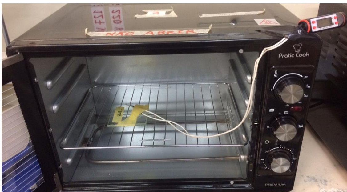
Figura 37: Adaptação realizada na haste do termômetro culinário para controle da temperatura interna do forno.
